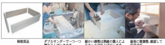
桐箱部品 ダブルサンダーで一つ一つ擦り込んでいきます。細かい調整は熟練の職人によりカンナで仕上げています。最後に微調整、確認して完成です。
